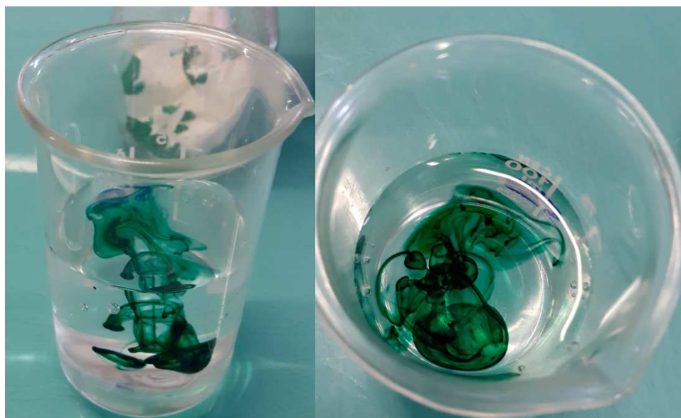
Figure 8 : Exemple d'une expérience permettant de comprendre le principe de diffusion à l'aide d'un bécher rempli d'eau et de colorants
