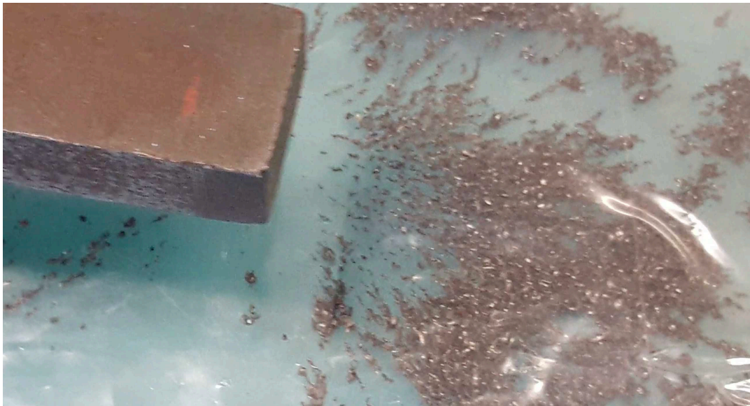
Figure 5 : Formation de lignes de champs à l'aide de limaille de fer et d'un aimant
