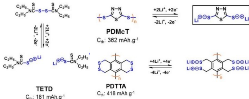
FIGURE 1.10 – Formules, réactions d’oxydo-réduction et capacités spécifiques de plusieurs organo-sulfures
