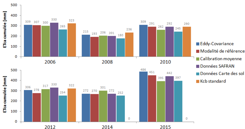
Figure III-9: Comparaison du cumul d'ET ca (mm) mesuré par Eddy-Covariance et simulé par SAFYE durant la période de végétation pour les six années, avec les différentes modalités. Les Kcb ref n'étaient pas disponibles en 2014 et 2015.
