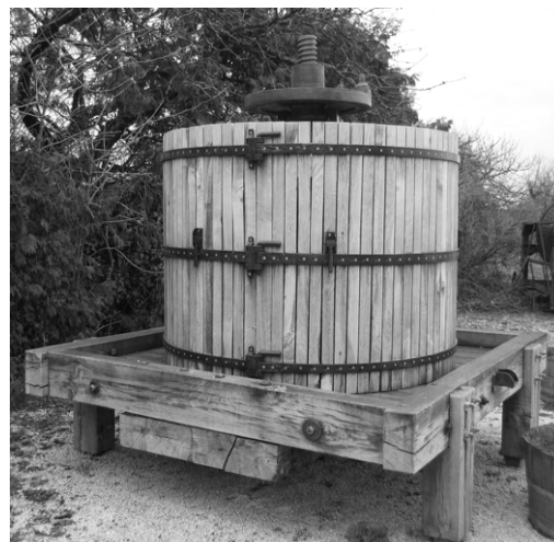
Figure 88. Pressoir à vin traditionnel en bois (source Wikimedia).
