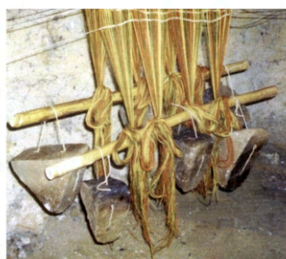
Fils de chaînes tendus par l'intermédiaire de deux baguettes auxquelles sont accrochés les pesons
