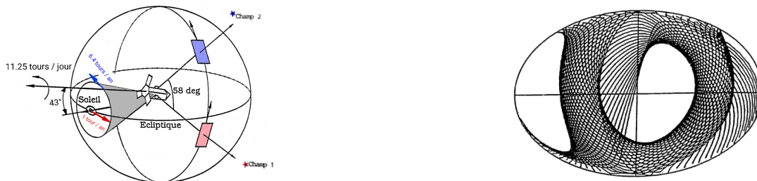
FIGURE 2.1 – Gauche : balayage du ciel par Hipparcos. Droite : balayage du ciel par les 2 champs d'Hipparcos sur une période de 70 jours. Crédit : Jean-Louis Falin.
