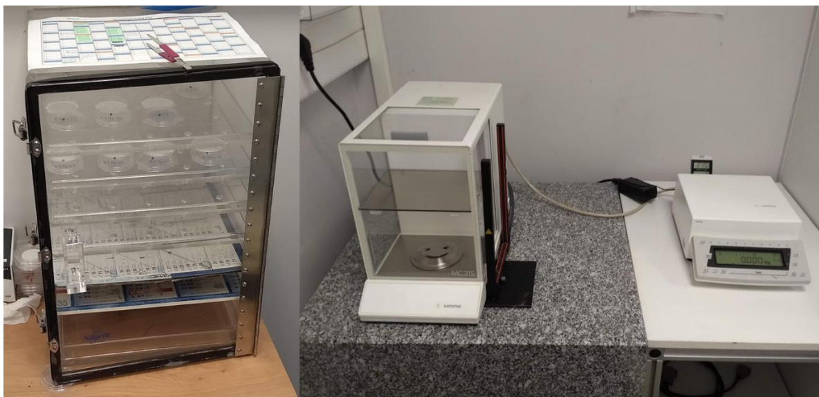
Figure 2.11 : Balance submicronique (à droite) et l'étuve d'exposition des filtres avant la pesée (à gauche).
