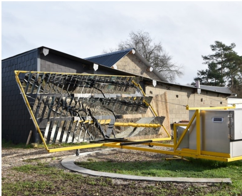
Four solaire pour torréfaction - boulangerie. Source : © Julien Lemaistre - Low-tech Lab.
