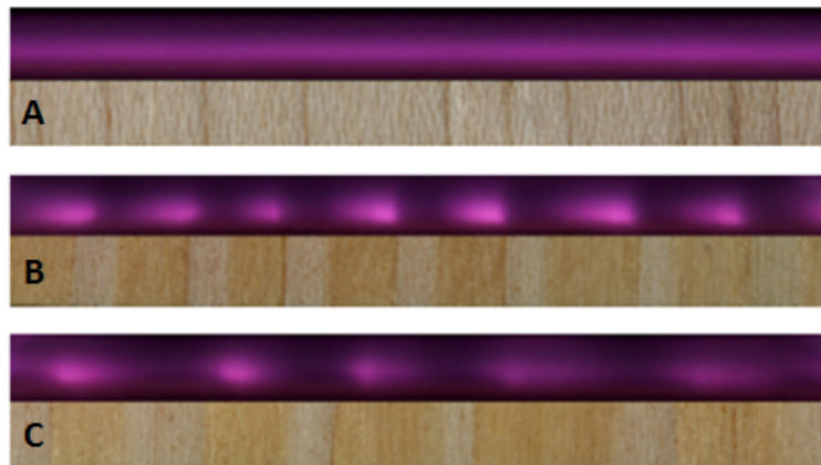
Figure 33: Structuration de la DLPA dans l'hélium en présence d'un substrat de bois : a) érable à sucre, b) et c) pin Douglas
