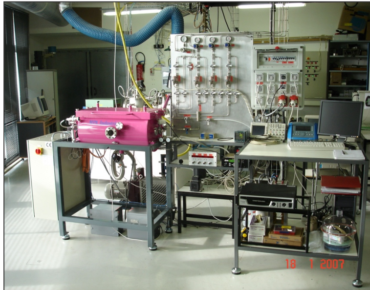
Figure 45: Photographie du dispositif expérimental pour le dépôt de couches anti-reflets et de passivation pour cellules photovoltaïques par plasma froid à la pression atmosphérique (Laboratoire PROMES – Perpignan)
