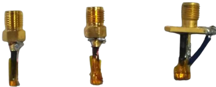
FIGURE 2.95 – Sondes composées d'un ruban de 1, 5 et 9 spires.
