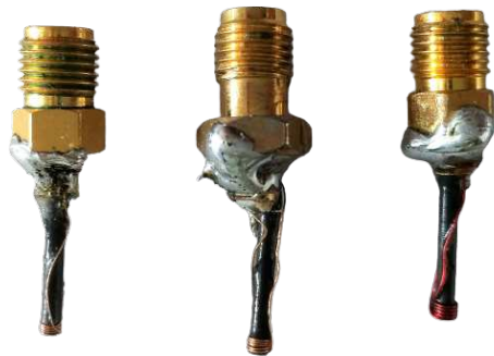
FIGURE 2.100 – Sondes avec diamètres de fil de 100 \mu\text{m} , 150 \mu\text{m} et 200 \mu\text{m} .
