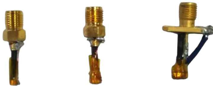
FIGURE 2.95 – Sondes composées d'un ruban de 1, 5 et 9 spires.
