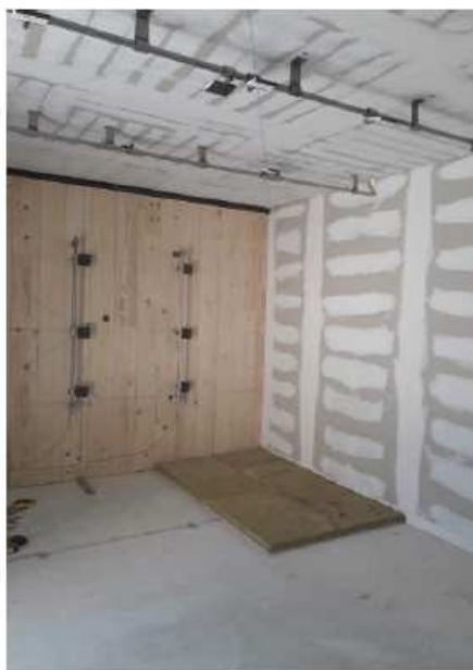
Figure II- 108 : A gauche, vue du compartiment d'essai sous feu naturel avec le mur en CLT non protégé. A droite, évolution de la température (moyenne et dispersion) mesurée à l'interface entre les deux plaques de plâtre de 18 mm (« Interface ») et en surface du bois protégé (« Surface ») dans le cas de l'essai naturel et conventionnel (« ISO Curve »).
