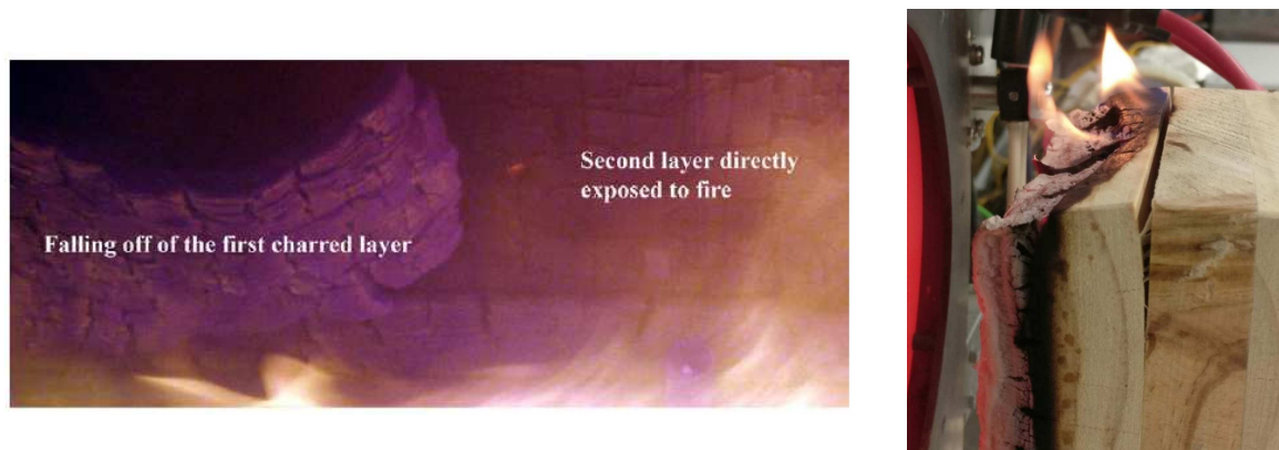
Figure II- 77 Observation de la délamination d'un CLT durant à gauche un essai de résistance au feu réglementaire [156] et à droite durant une exposition à un cône calorimétrique [151].
