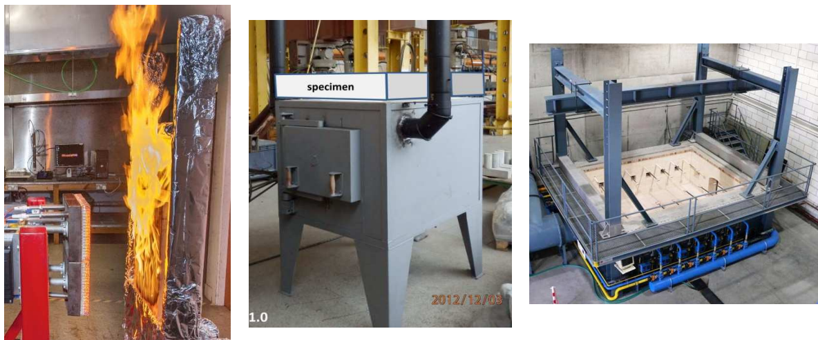
Figure II- 111 : Illustrations de quelques moyens expérimentaux universitaires. De gauche à droite : dispositif « HTRIS » de l'Université d'Edinburgh, four à dalles (surface exposée au feu de 750 x 950 mm) de l'Université de Cracovie et four horizontal à grande échelle de l'Université de Liège.
