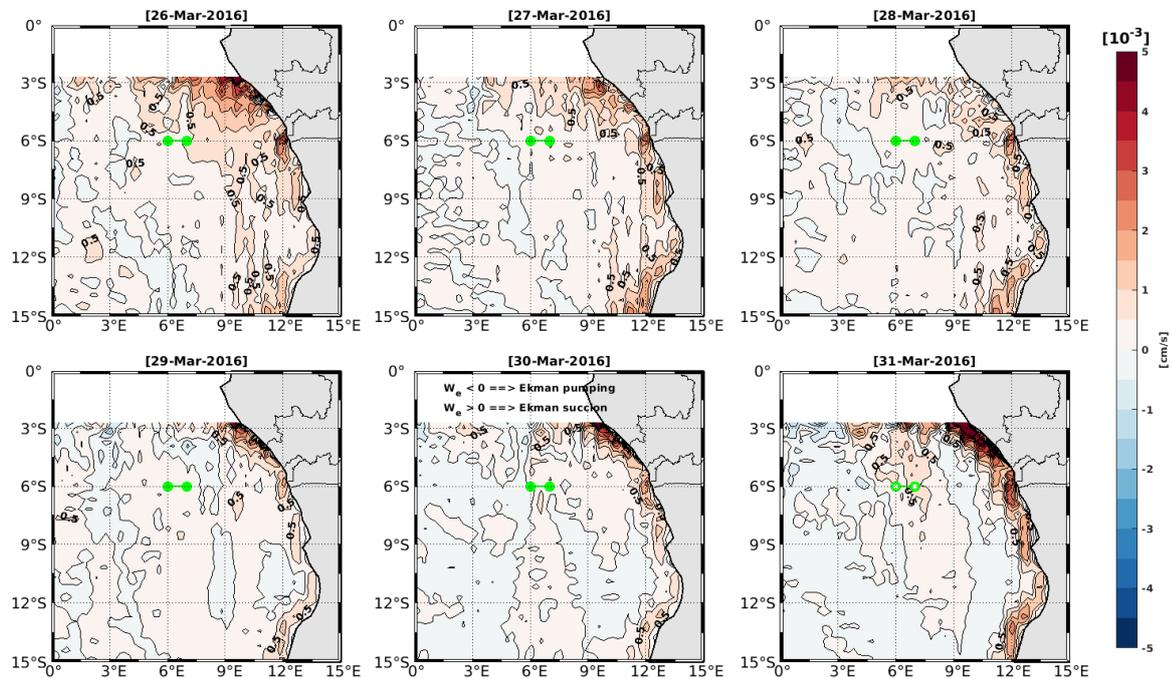
FIGURE 4.21 – Vitesse de pompage d'Eman associée aux variations spatio-temporelles de SSS et de SST. Les points verts représentent les positions des profils d'observation de structure thermohaline en marches d'escalier.
