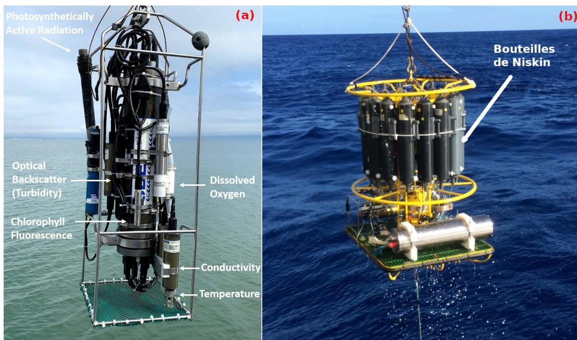
FIGURE 2.8 – Instrument de mesure CTD embarqué avec des capteurs d'oxygène dissout («Dissolved Oxygen»), de turbidité («Turbidity»), de Fluorescence («Chlorophyll Fluorescence») et de mesure d'activité de photosynthèse («Photosynthetically Active Radiation»). Image tirée de : <https://www.usgs.gov/media/images/water-quality-san-francisco-bay-ctd-instrument-package>.
