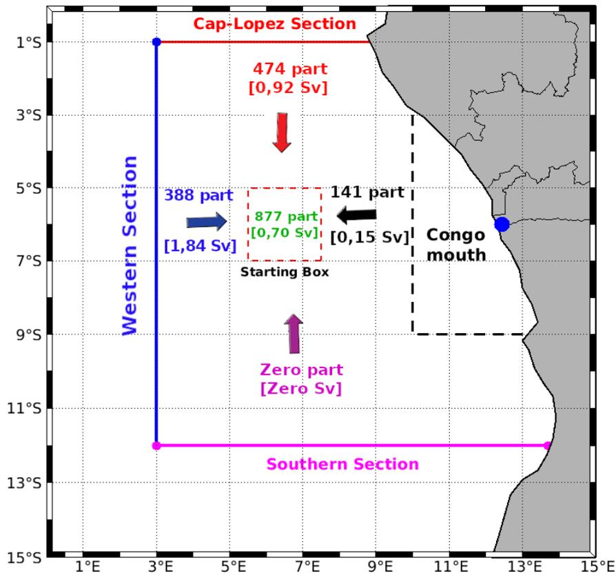
FIGURE 5.2 – Bilan des particules d'eau et transport de volume de masse d'eau associé. Les valeurs indiquées autour des flèches, représentent le nombre de particules (« part ») ayant intercepté chaque section et le transport de volume d'eau équivalent (mis en crochet). Les valeurs indiquées couleur verte sont pour les particules qui ont eu des trajectoires de détours dans la « Starting box » (« Meander Particles »).
