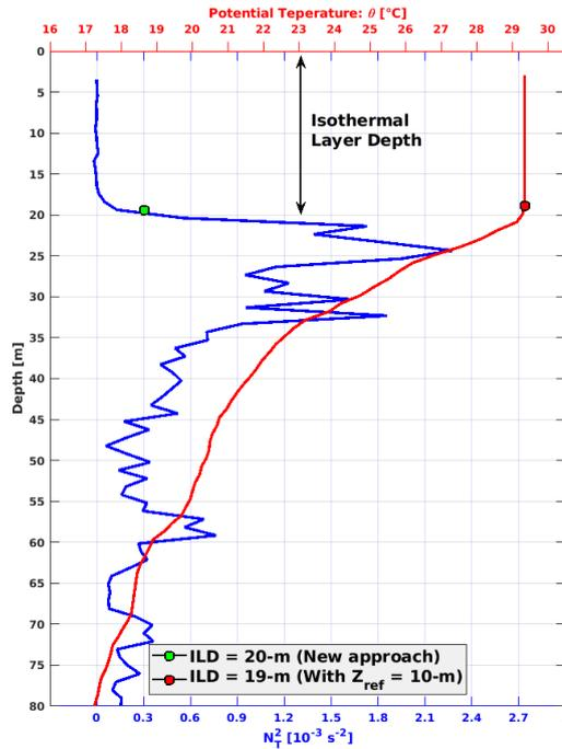
FIGURE 2.17 – Exemple de schéma de détection de la couche de mélange, avec un profil de CTD PIRATA FR29 (15/03/2019). Le point vert représente la *ILD* estimée avec notre méthode tandis le rouge est basé sur la méthode de de Boyer Montégut et al., 2004.
