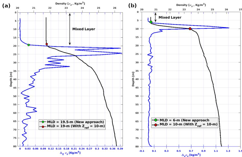
FIGURE 2.16 – Exemples de schémas de détection de la couche mélangée, avec des profils CTD PI-RATA : (a) FR29 (15/03/2019) et (b) FR26 (01/04/2016). Le point vert représente la MLD estimée avec notre méthode tandis que le point rouge indique la MLD basé sur la méthode de de Boyer Montégut et al., 2004.
