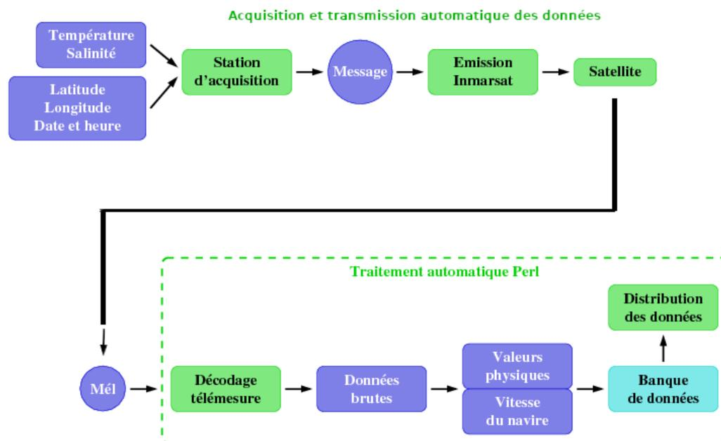
FIGURE 2.3 – Schéma de la chaîne d’acquisition, de transmission et de traitement automatique des mesures de salinité et de température TSG. L’algorithme de traitement automatique est codé dans le langage informatique Perl. Image modifiée adaptée et adaptée du site web du Service d’Observation de la Salinité : <http://www.legos.obs-mip.fr/fr/share/soa/cgi/getobs/v0.2a/index.pl.cgi?contexte=S0A&donnees=TSG&suivi=TPS-REEL&env=NAVIRE&menu=DOC>.
