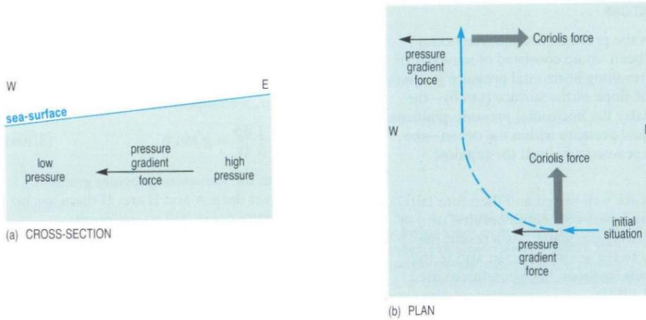
FIGURE 2.19 – (a) Section verticale zonale dans la colonne d'eau, avec la haute pression à l'Est et la basse pression à l'Ouest : on observe un gradient de pression de l'Est à l'Ouest. (b) vue en surface du flux géostrophique dérivant à droite de la force de gradient de pression sous l'effet de la force de Coriolis [D'après Evelyn et al., 2001].
