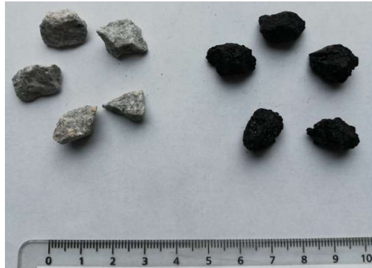
Figure 109. Forme des granulats neufs de granite (à gauche) et d'agrégats d'enrobé (à droite).
