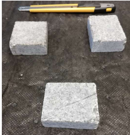
Figure 137. Lames sciées de granite.
