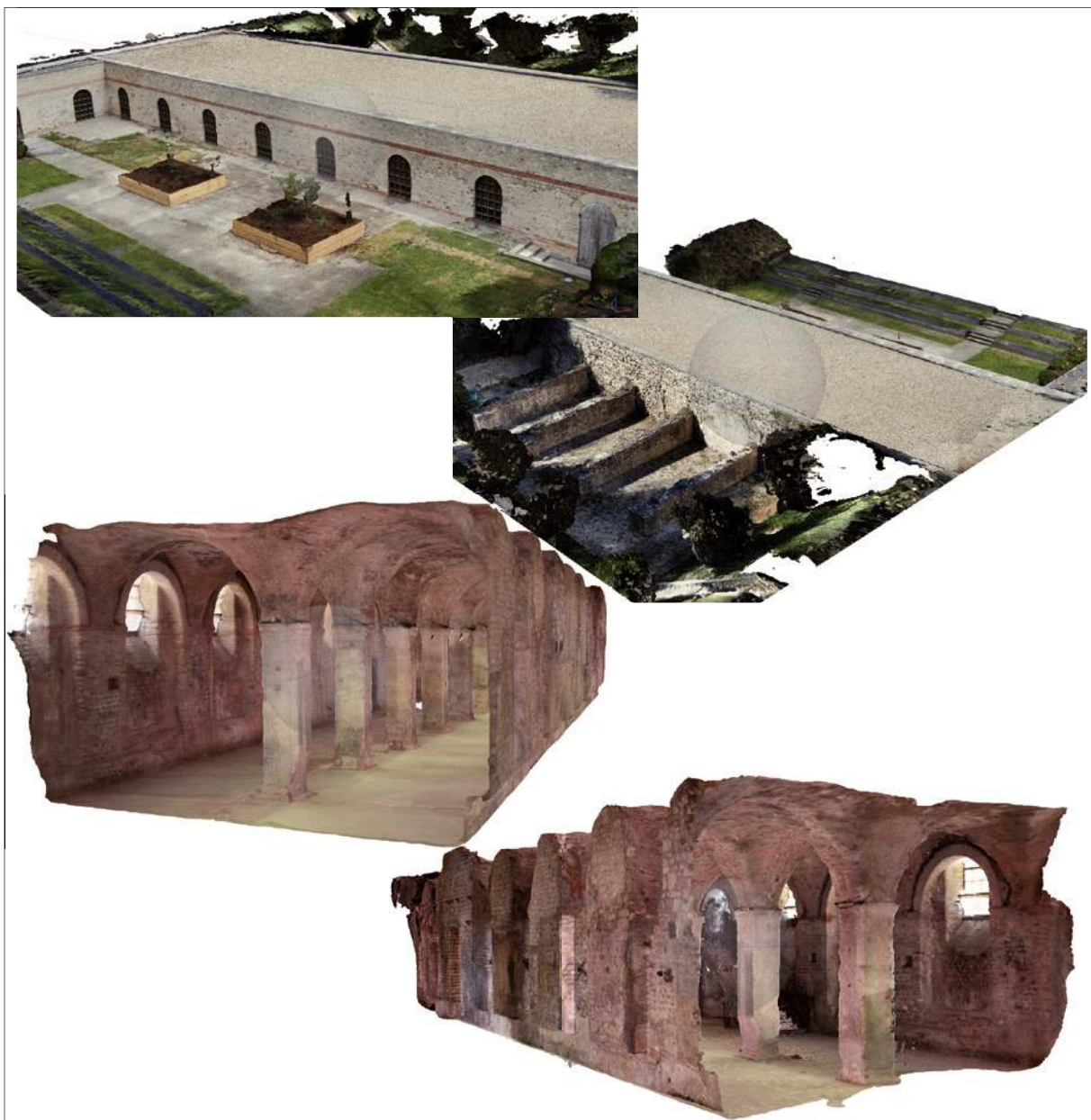
Figure IV-7. Vues extraites de la modélisation photogrammétrique du Cryptoportique
