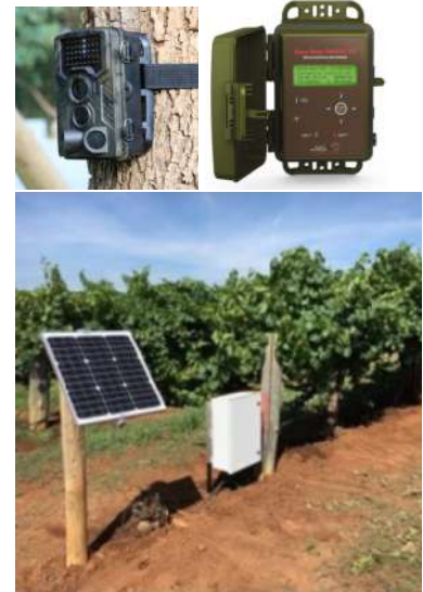
FIGURE 3.2 – Exemples de capteurs pouvant être utilisés simultanément dans une parcelle et sa bordure avec, de haut en bas et de gauche à droite, un piège photo, un enregistreur sonore et une centrale de mesure des conditions édaphiques.
