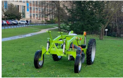
FIGURE 6.2: Tracteur autonome agricole élaborée par la société Elatech
