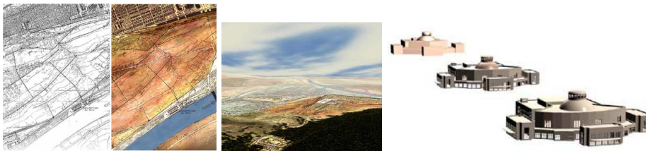
FIG. 2.12 – La “Cité Industrielle” de Tony Garnier [MBST01]. À gauche, une parcelle du plan général du site dessiné par Tony Garnier, et la même parcelle après texturation non photo-réaliste. Au milieu, une vue aérienne de la cité virtuelle. À droite, un exemple de niveaux de détail pour la salle des auditions.
