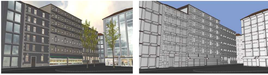
FIG. 3.21 – Exemple d'environnement modélisé à l'aide de règles de décomposition [WWSR03].
