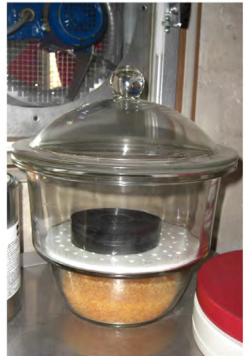
n°5, photographie d'un film 35 mm exposé aux vapeurs d'acétone à l'ECPA-D
