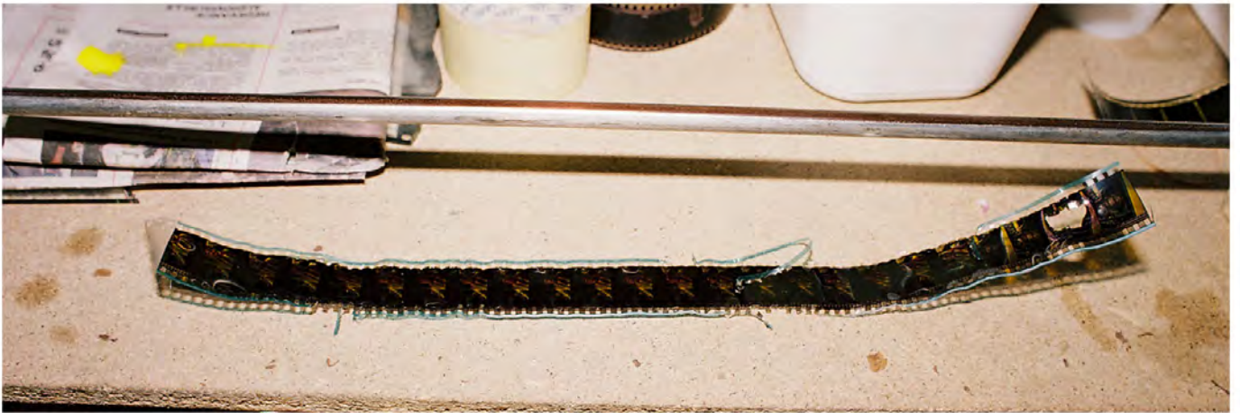
n°10, photographie d'une pellicule 35 mm polyester après rupture d'un bras de projecteur
