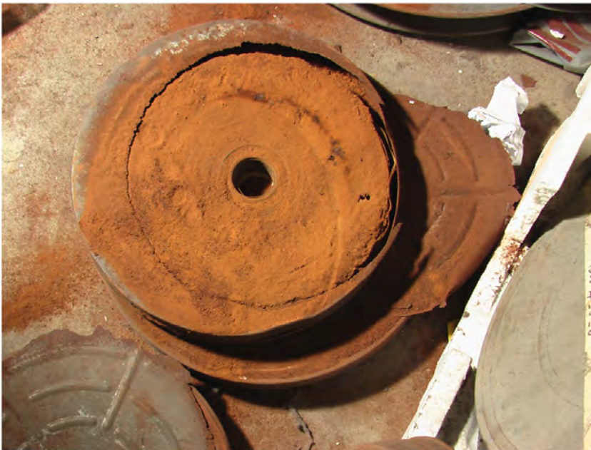
n°3, photographie d'un film 35 mm en support nitrate après décomposition
