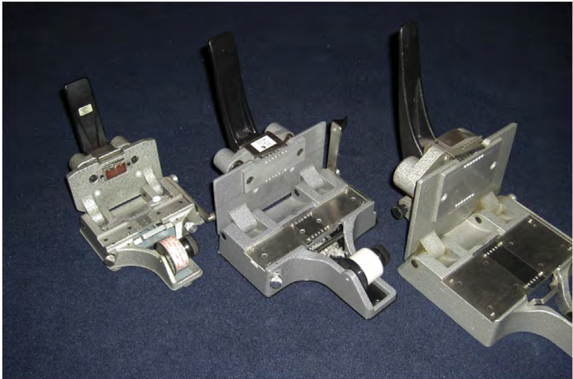
n°18, photographie des trois formats de colleuses 16 mm, 35 mm et 70 mm
