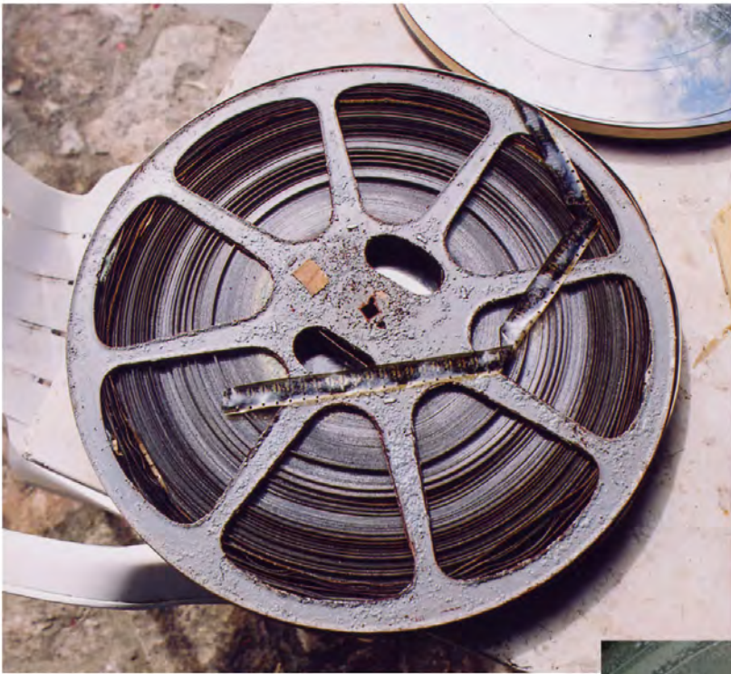
n°6, photographie d'un film 16 mm victime d'un syndrome du vinaigre
