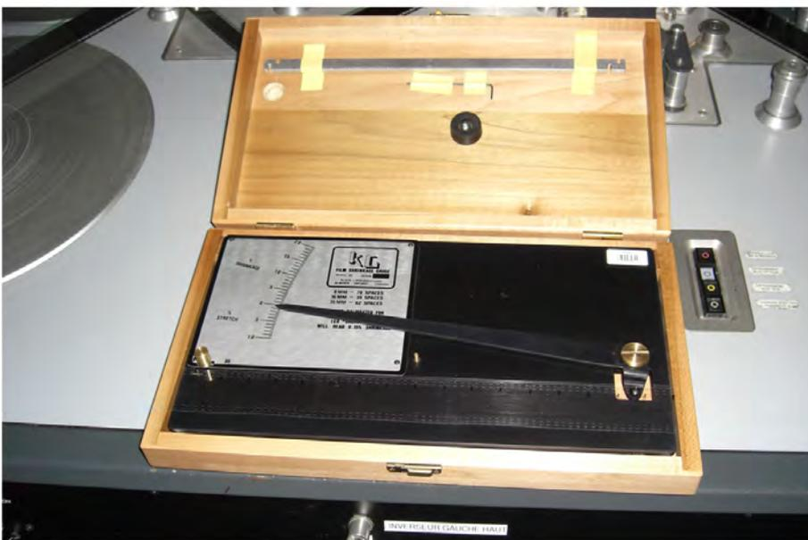
n°4, photographie d'un appareil de lecture du niveau de retrait pour 35 mm en support nitrate
