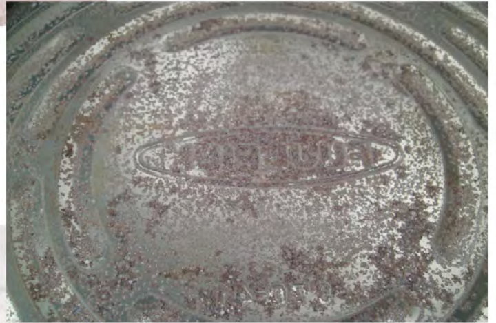
n°7, photographie d'une boîte métal 35 mm de marque Fuji oxydée de l'intérieur
