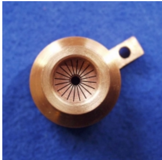
figure II.2 : échangeurs en étoile fabriqués par électroérosion (diamètre extérieure : 30 mm)
