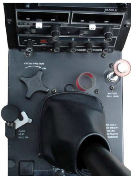
Fig. 7: Base de la commande cyclique avec une molette permettant régler la friction sur un R44.
