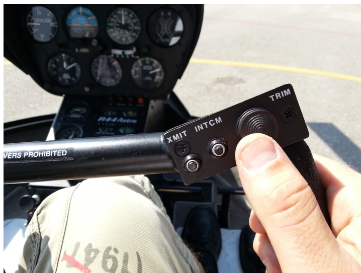
Fig. 8: Beep trim (ou chapeau chinois) sur la commande de cyclique d'un R44.
