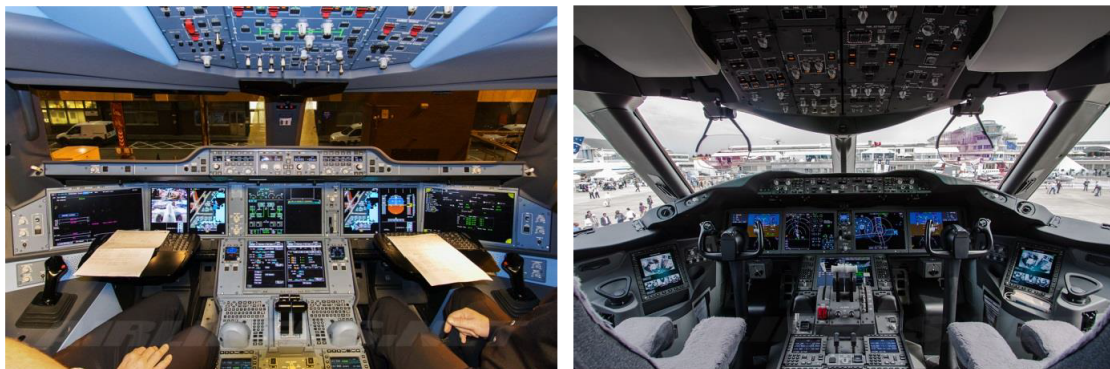
Fig. 1: A gauche, une cabine d'un airbus A350 XWB équipé des mini manches passifs ; à droite, un Boeing 787-900 doté des manches en forme de "U", ou "yokes".
