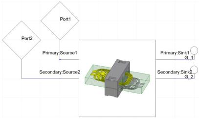
Figure II-25: S parameter analysis in Ansys Circuit Design
