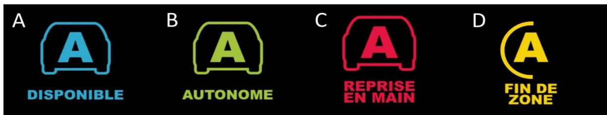
Figure C.2. Pictogrammes affichées sur la l'IHM de la tablette: A: conduite autonome disponible; B: conduite autonome activée; C: demande de reprise en main non planifiée (8s); D: demande de reprise en main de fin de zone de conduite autonome (45s)
