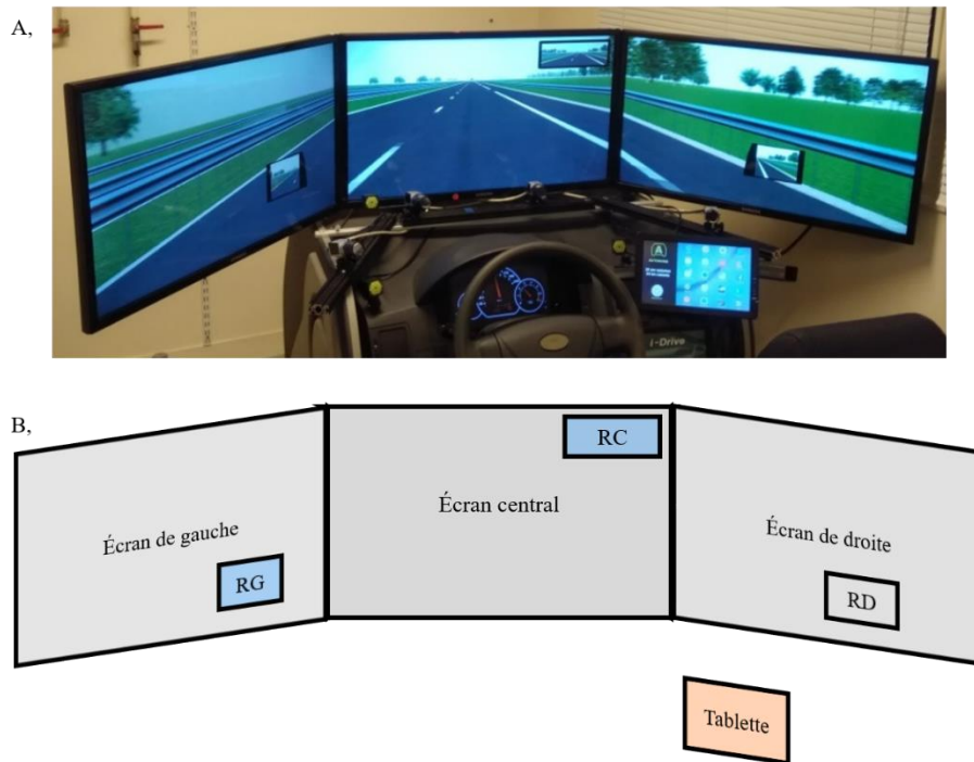
Figure E.3. A. Simulateur du LS2N. B. Aires d'intérêt considérées pour l'analyse du comportement visuel : la route en gris (central screen), le rétroviseur gauche (LM) et le rétroviseur central (CM) en bleu, la tablette (tablet) en orange.
