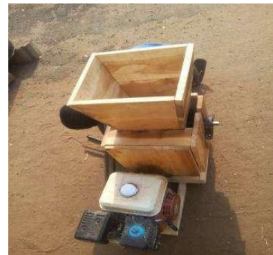
Figure 3-6: Râpeuse éco conçue fabriquée
