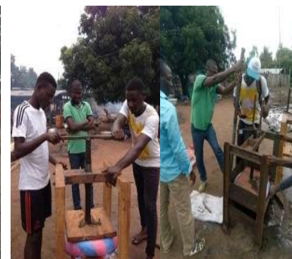
Photo 2-6 : Pressage de pulpe de manioc avec les deux presses
