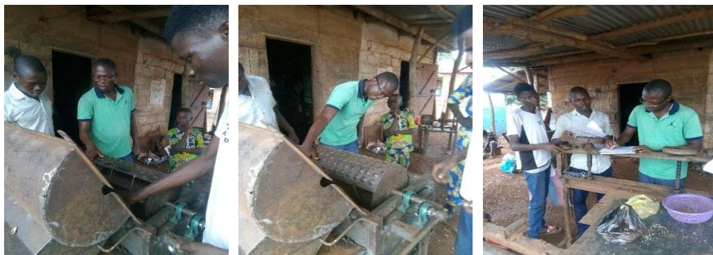
Photo : 2-7 : Visualisation de la grille du tambour de la décortiqueuse d'arachide
