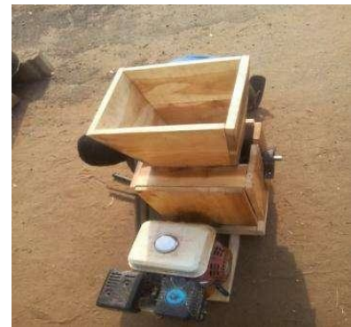
Figure 3-6 : Râpeuse éco conçue fabriquée
