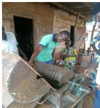
Photo : 2-8 : Visualisation du tambour de la décortiqueuse d'arachide
