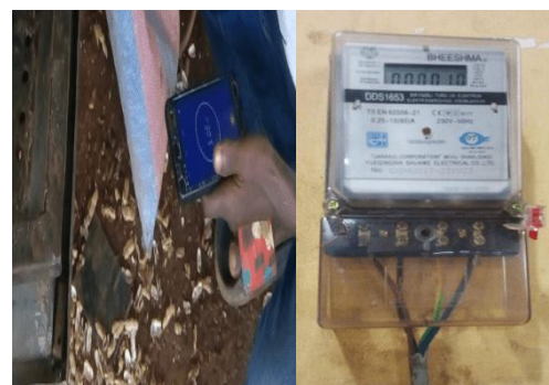
Photo 2-3 : Mesure du temps et d'énergie consommée pour le râpage
