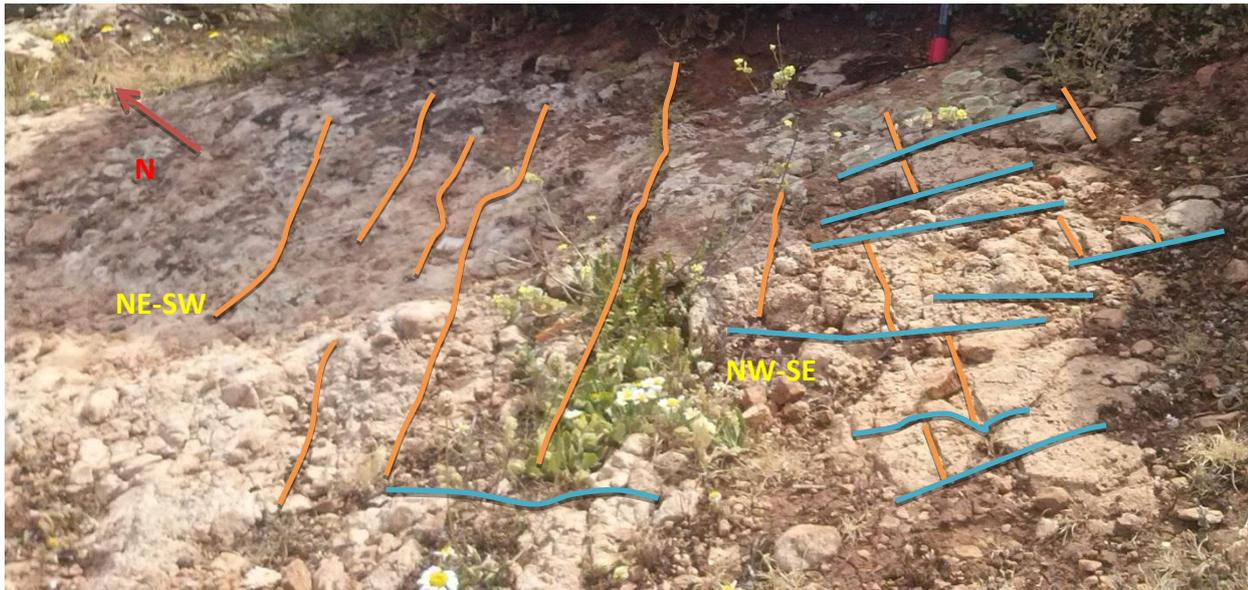
**Photo 15: représentation de la fracturation mesurée dans la station 1**
