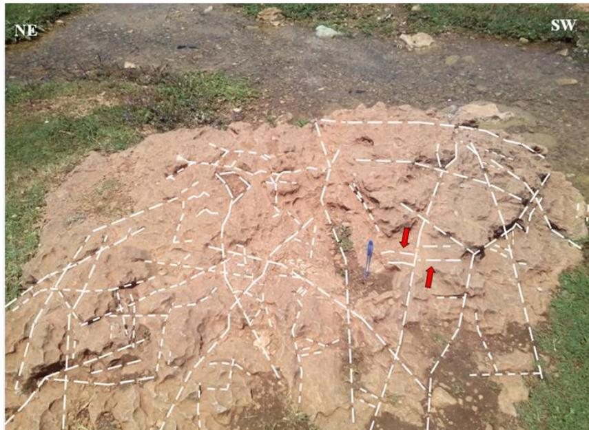
**Photo 8: représentation de la fracturation mesurée dans la station 3**
