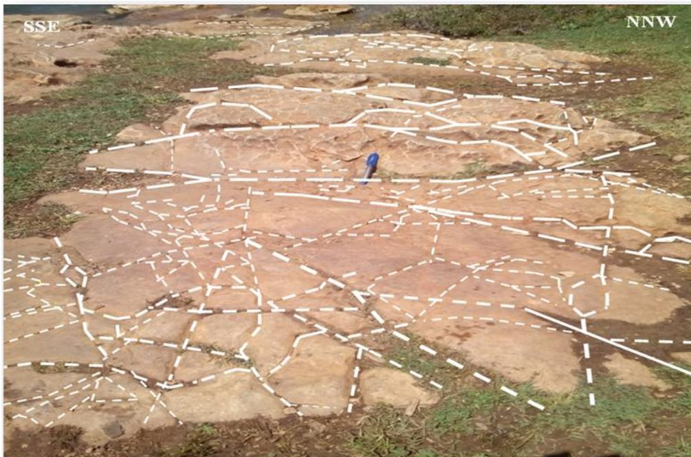
**Photo 7 : représentation de la fracturation mesurée dans la station 2 à Ain Maarouf**
