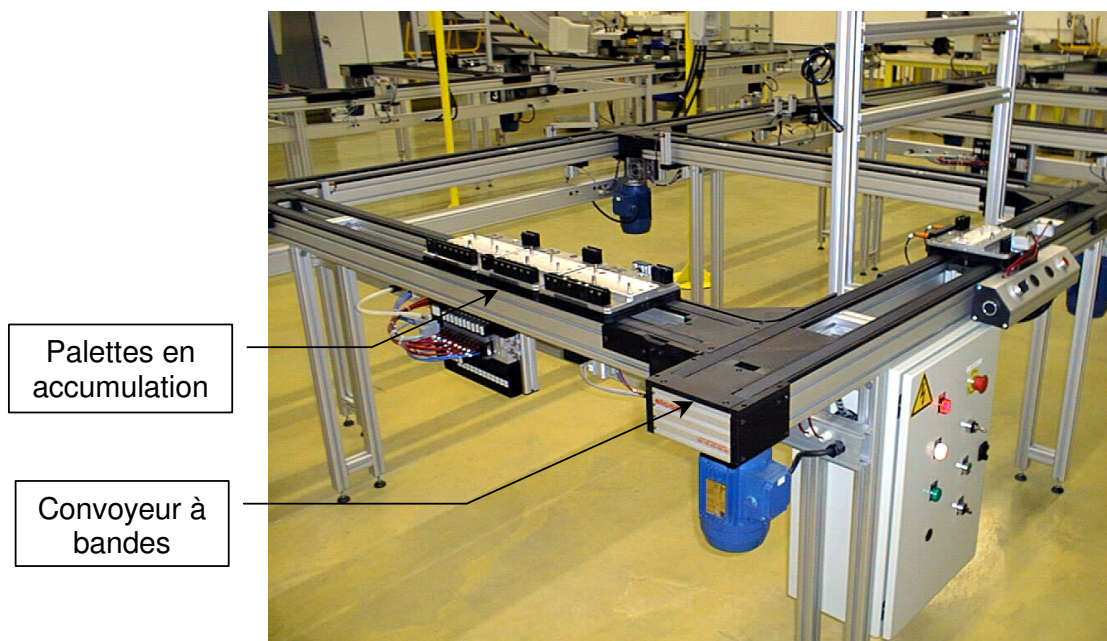
Figure 5 : Exemple d'entraînement par palettes libres
