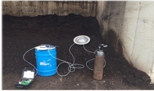
Figure 17. Chambre de flux pour un prélèvement surfacique
