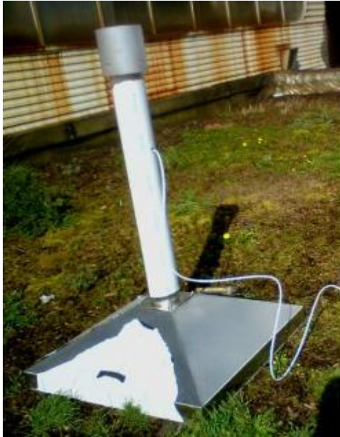
Figure 16. Schéma d'une cloche munie d'une cheminée. Source : https://docplayer.fr/40428989-Irh-ingenieur-conseil-etude-des-emissions-odorantes.html
