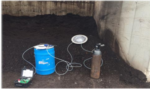
Figure 17. Chambre de flux pour un prélèvement surfacique
