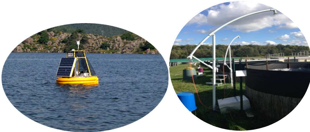
Figure 9. Bouée de mesures développée lors du projet Proliphyc sur la retenue de Grangent, capteur de réflectance du projet OSS cyano lors de sa validation sur mésocosme à l'écotron de Foljuif.
