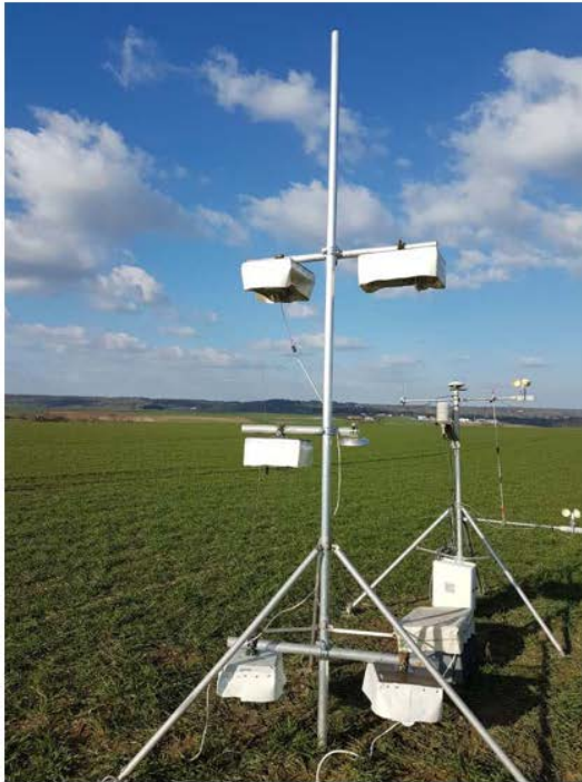
figure 16 : illustration du système de badges avec une exposition à l'air ambiant conditionnée à des critères spécifiques. Les badges sont positionnés à plusieurs hauteurs pour évaluer le différentiel entre chaque niveau. La photo et le schéma montrent une des expérimentations menées pour comparer les conditions d'exposition des badges (exposition en fonction de l'heure, le jour/nuit ou en fonction de la stabilité atmosphérique).
