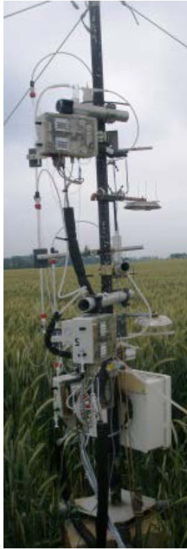
figure 13 : Photo montrant un dispositif de mesure du gradient d' NH_3 à l'aide d'un analyseur à flux continu multi-canaux équipé de denuders liquides (ROSAA) (Loubet et al., 2012).
