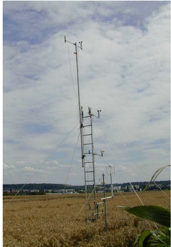
figure 1 : illustration d'un dispositif de mesures pour estimer des flux de gaz entre un couvert végétal et l'atmosphère.
