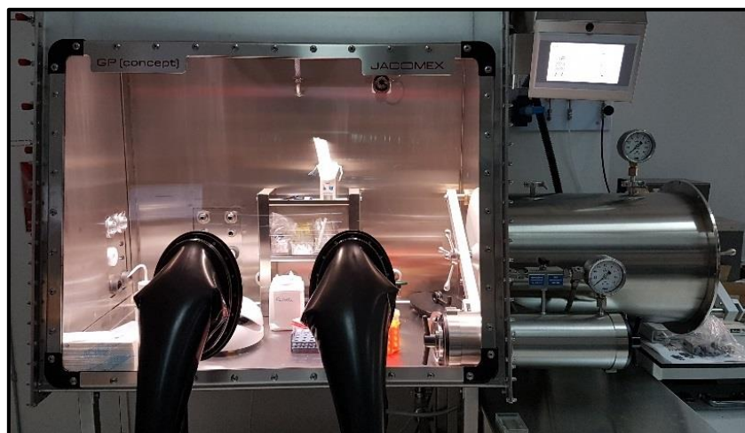
Figure 46 : Boîte à gants multifonction conçue pour accueillir, entre autres, un système automatisé de congélation des grilles de cryoEM (Vitrobot™).
