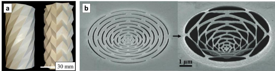
Figure 70: Exemple de structures basées sur l'origami (a, adapté de (LANGFORD ET AL. 2021)) et le kirigami (b, adapté de (JIAFANG LI & LIU 2018)).
