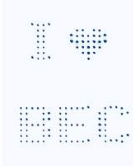
FIGURE 5.1 – Exemple d’image obtenue par une “imprimante à condensats de Bose-Einstein”. Chaque colonne de points est une image d’absorption de la distribution d’impulsion du condensat après contrôle optimal.
