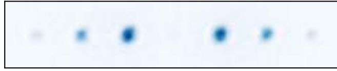
FIGURE 3.6 – Image expérimentale d'un condensat après diffraction par le réseau. Le temps de pulse du réseau est assez court pour que l'approximation de Raman-Nath soit valide ( \tau = 18 \mu\text{s} ) et correspond à l'extinction de la population dans l'ordre zéro de diffraction.
