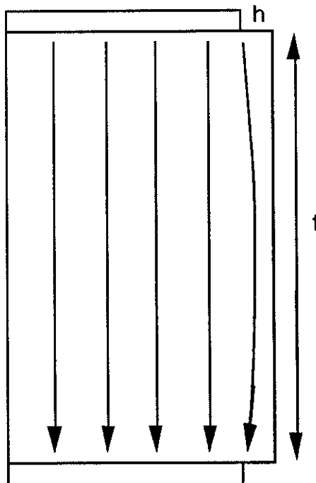
Fig. 8 Lignes de courant peu perturbées dans le cas d'un cristal très épais.
