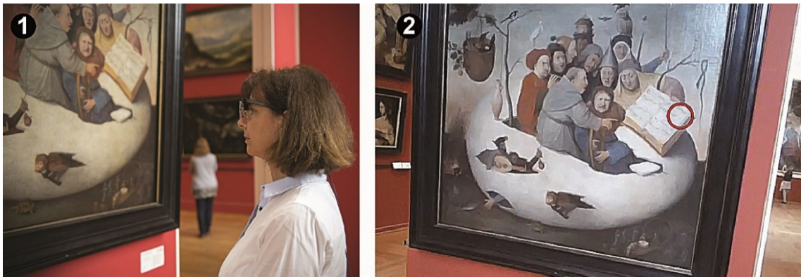
Figure 2. Le visiteur est équipé d'un eye tracker puis laissé à sa visite. L'eye tracker enregistre la perspective subjective visuelle et auditive du visiteur en indiquant le point de focalisation de son regard (gaze point) sur l'image vidéo (photos 2017 Daniel Schmitt).
