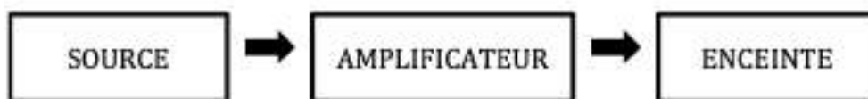
Figure 14 Système minimal du sound system et base du circuit électro-acoustique du son
