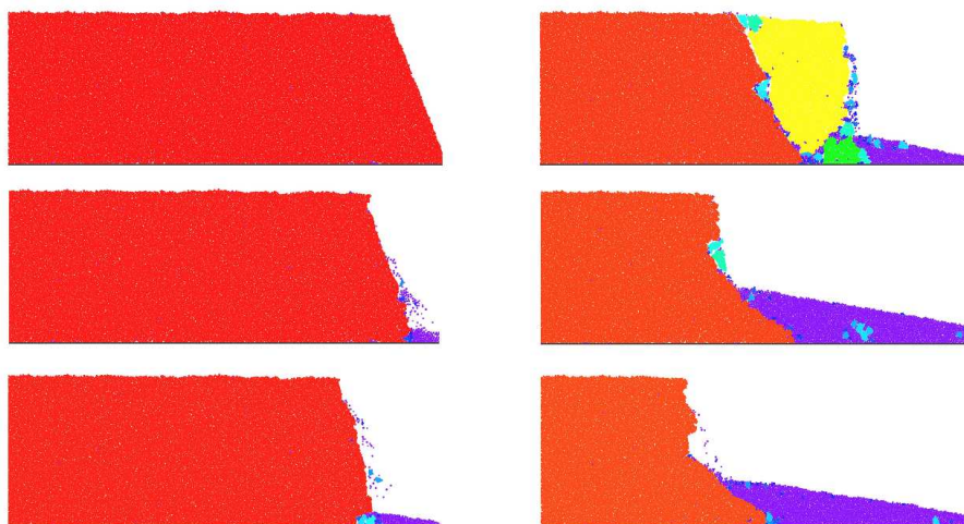
FIGURE 2.12 – Illustration de la simulation de l'évolution d'un massif initialement cohésif, et fragilisé de manière aléatoire sur une certaine épaisseur le long de la falaise. On note la croissance progressive d'un talus issu des débris des éboulements successifs, et qui vient protéger le pied de la falaise. Pour s'affranchir de cet effet, il est également possible d'éliminer ces débris au fur et à mesure.
