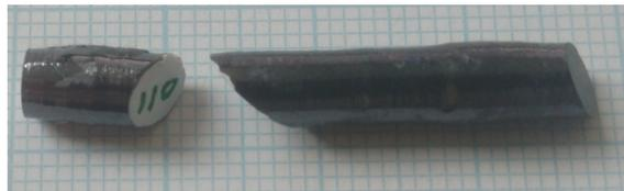
FIGURE V.1 – Monocristal C119 de  $\text{Tb}_2\text{Ti}_2\text{O}_7$ .
