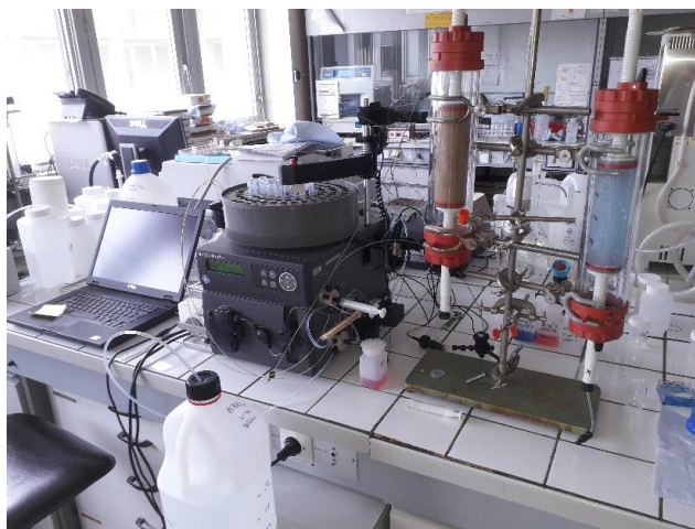
Figure 50 : dispositif d'injection ÄKTAprime Plus© avec deux colonnes montées (une de sable et l'autre de billes de verre)
