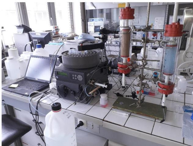
Figure 50 : dispositif d'injection ÄKTAprime Plus© avec deux colonnes montées (une de sable et l'autre de billes de verre)
