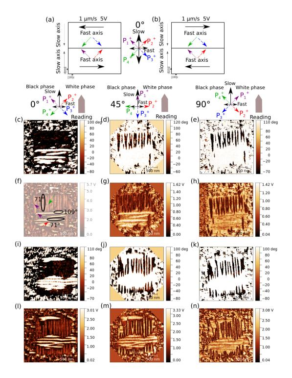
FIGURE 11 : Schéma pour l'expérience 1 et (b) schéma pour l'expérience 2 sur BFO à 0°. Image de phase latérale pur l'expérience 1 à (c) 0°, (d) 45° et (e) 90°, et les images respectives d'amplitude (f),(g) and (h). Image de phase latérale pur l'expérience 2 à (i) 0°, (j) 45° and (k) 90°, et les images respectives d'amplitude (l),(m) and (n). L'image (f) montre les differentes directions de polarisation obtenues pour les expériences.
