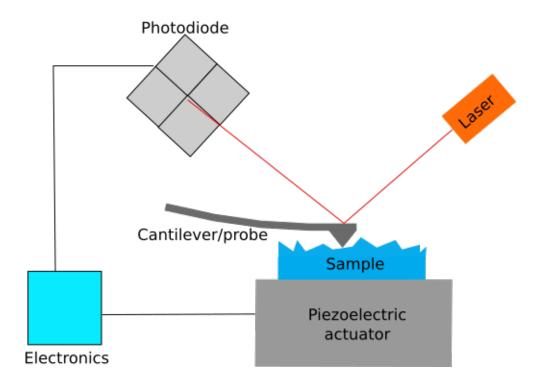
FIGURE 5 : Schéma d'un AFM avec ses composants principaux.
