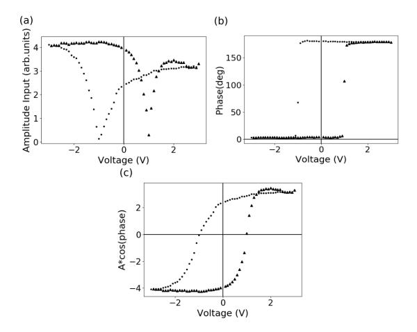
FIGURE 9 : Cycles de SS-PFM sur PZT. (a) Amplitude, (b) phase et (c) signal X. La tension coercitive peut être observée comme les points avec le minimum de signal pour (a) et les point où la phase change pour (b).
