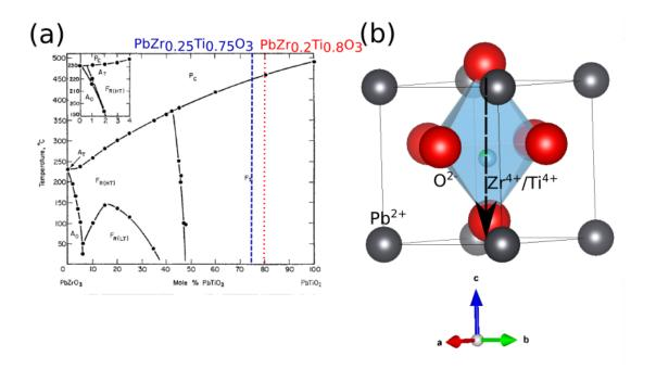
FIGURE 3 : (a) Differentes phases de PZT (Jaffe et al., 1971) et (b) structure tetragonale de  $Pb[Zr_{0.2}Ti_{0.8}]O_3$
