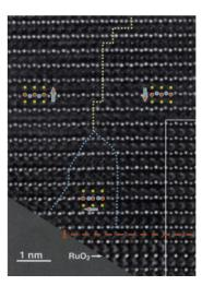
FIGURE 2 : À gauche, un schéma de deux domaines séparés par une paroi de domaine (bleu). À droite, image de microscopie électronique en transmission à haute résolution avec trois domaines et leurs parois de domaine (ligne à points) sur  $PbZr_{0.2}Ti_{0.8}O_3$  (Jia et al., 2011).
