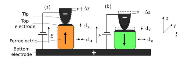
FIGURE 7 : Schéma pour le PFM vertical . (a) élongation d'un matériau ferroélectrique quand la polarisation est dans la même direction du champ électrique et (b) contraction quand la polarisation est opposée au champ électrique. (Brugère, 2011)
