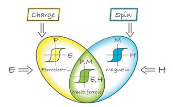
FIGURE 1 : Cycle d'hystérésis pour les matériaux ferroélectrique et ferromagnétique. (Khomskii, 2009)
