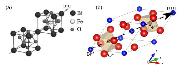
FIGURE 4 : (a) Structure pseudocubique (Ederer and Spaldin, 2005) et (b) structure rombohédrique de  $BiFeO_3$ .
