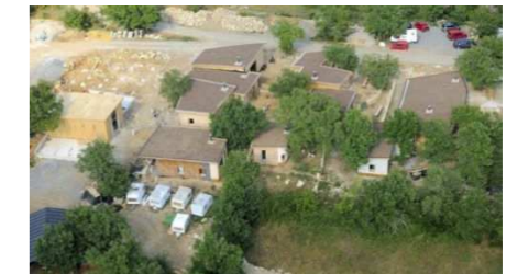
Vue aérienne des toitures semées de Sédums (plantes locales) des bâtiments
