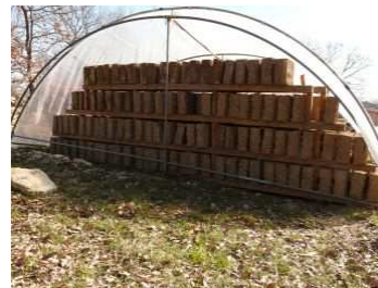
Briques de terre paille sous serre
