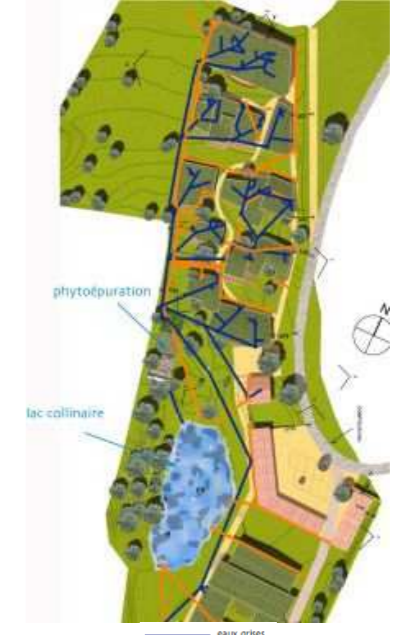
Plan des réseaux de récupération de l'eau
