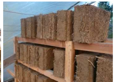
Briques de terre paille sous serre
