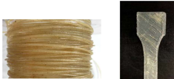
Figure 32: Conception de filament aux propriétés amortissantes
