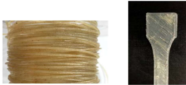
Figure 32: Conception de filament aux propriétés amortissantes
