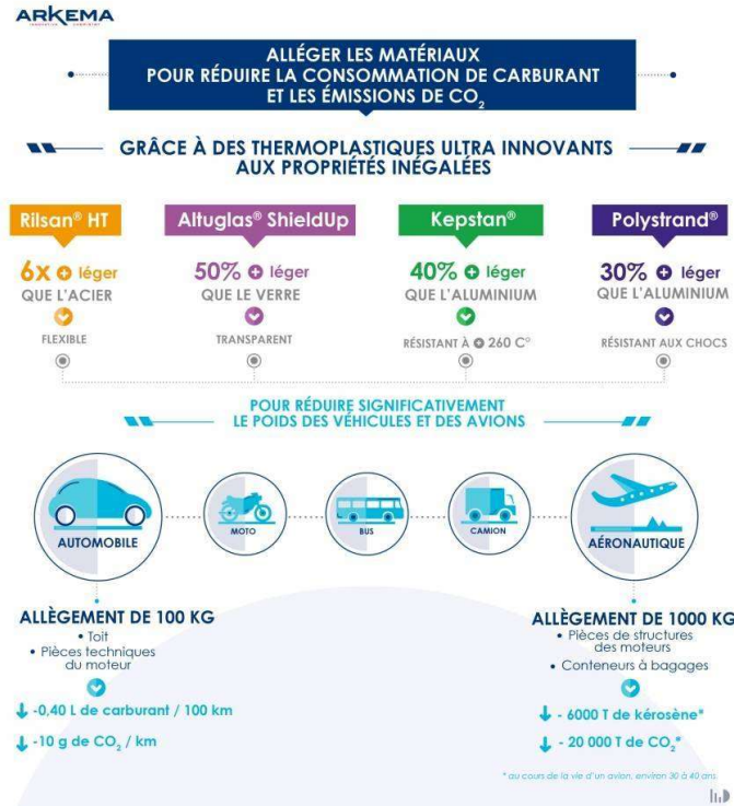
Figure 43 : Impact sur le poids des structures des thermoplastiques ARKEMA [3]
