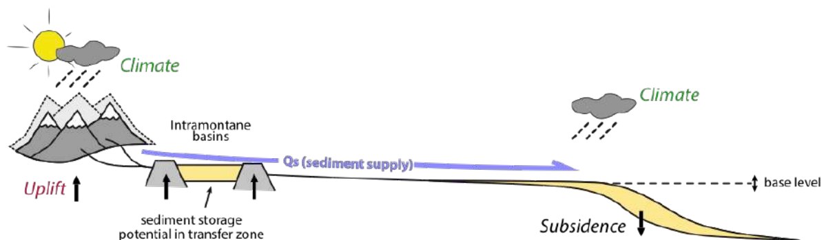
Figure 1-2 : Schéma conceptuel illustrant les facteurs de contrôle de la sédimentation sur un profil source to sink (modifié d'après Romans et al., 2015).
