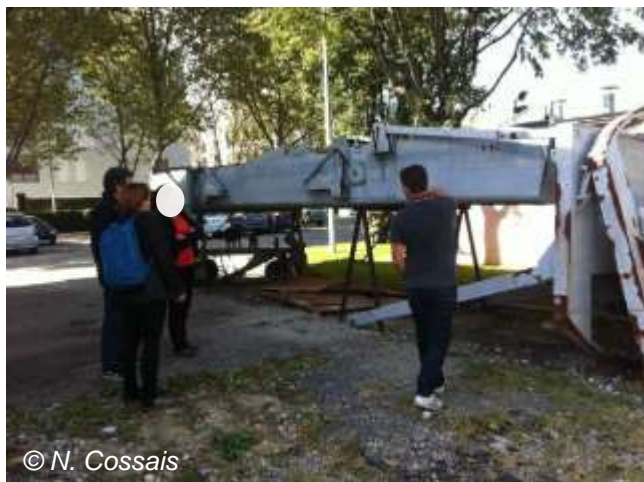
Matériel de curage manuel stocké sur le site ESX Bollier. À gauche, racle. À droite, bateau. Photographies N. Cossais. 2015
