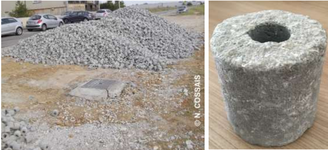
Figure 12 : Eléments préfabriqués Hydrocyl® pour le remplissage des bassins enterrés. À gauche : Stockage sur un chantier. Photographie du 14 septembre 2016. À droite : Elément isolé.
