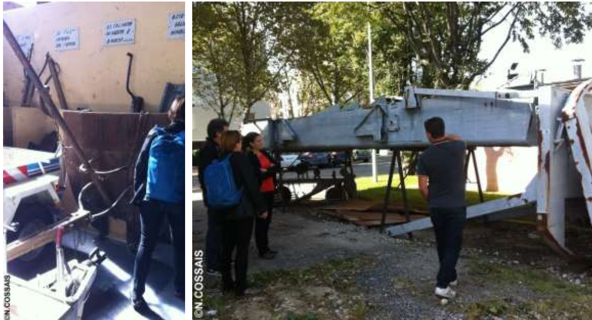
Figure 111 : Matériel de curage manuel stocké sur le site Bollier d'ESX. À gauche, racle : outil comportant une partie plate s'adaptant à différents profils de conduites. À droite, bateau permettant d'inspecter les plus gros collecteurs et de les désenvaser. Photographies du 25 septembre 2015.
